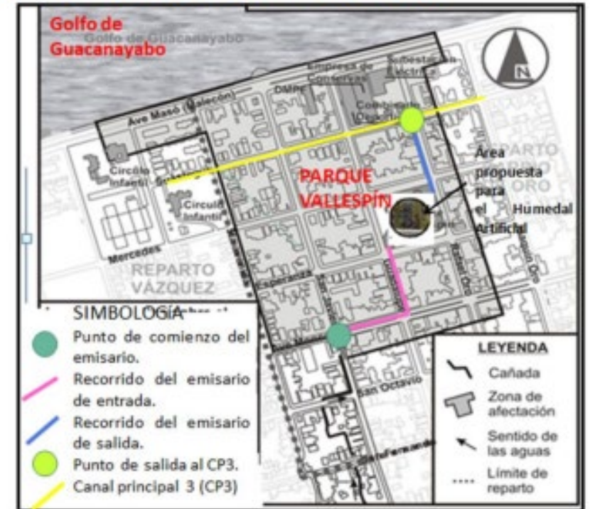
Detalle de localización del Humedal Artificial
