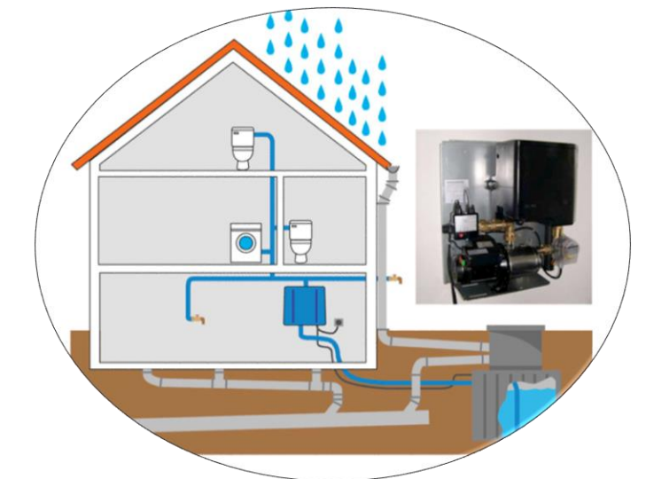
Sistemas de captación y filtración de agua de lluvia
