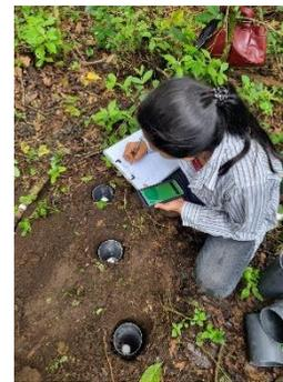
Para evaluar la humedad del suelo se utilizaron dos tipos de dispositivos: un registrador de humedad de suelo de la marca HOBO, el cual consiste en un sensor inalámbrico, que registra de forma instantánea, el contenido volumétrico de agua en el suelo. Las mediciones con este dispositivo se realizaron en los meses de agosto a diciembre 2023. Este registrador solamente fue instalado como control instantáneo en la parcela localizada en la Eco La T.
