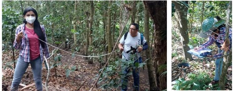
Para la delimitación de las parcelas en campo y medición de parámetros como la estimación de la pendiente del terreno, se utilizó los siguientes instrumentos de medición: GPS, cinta métrica, plomada, estacas marcadas y cordel; así mismo se identificó en campo los cuadrados con el número asignado en el procedimiento anterior a fin de ordenar la colecta de datos y sistematizar la información recolectada.
