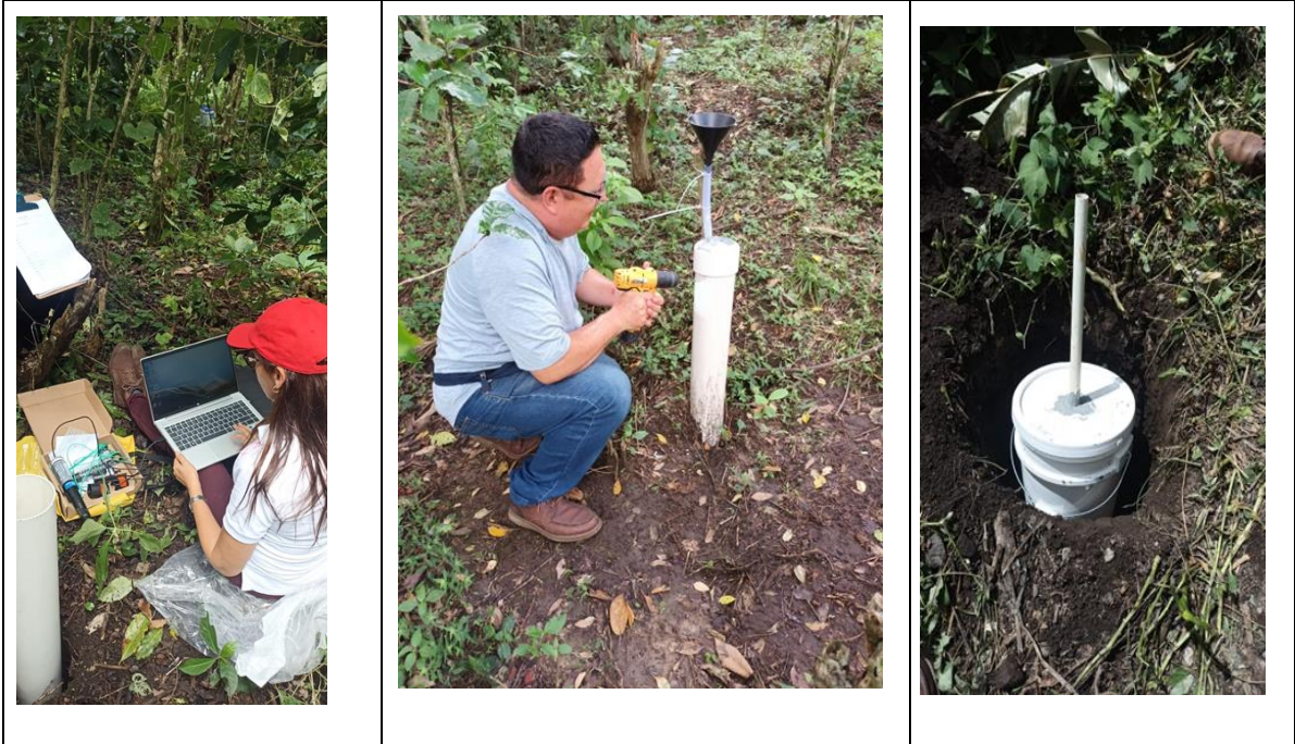
Instalación y programación del sensor data logger
