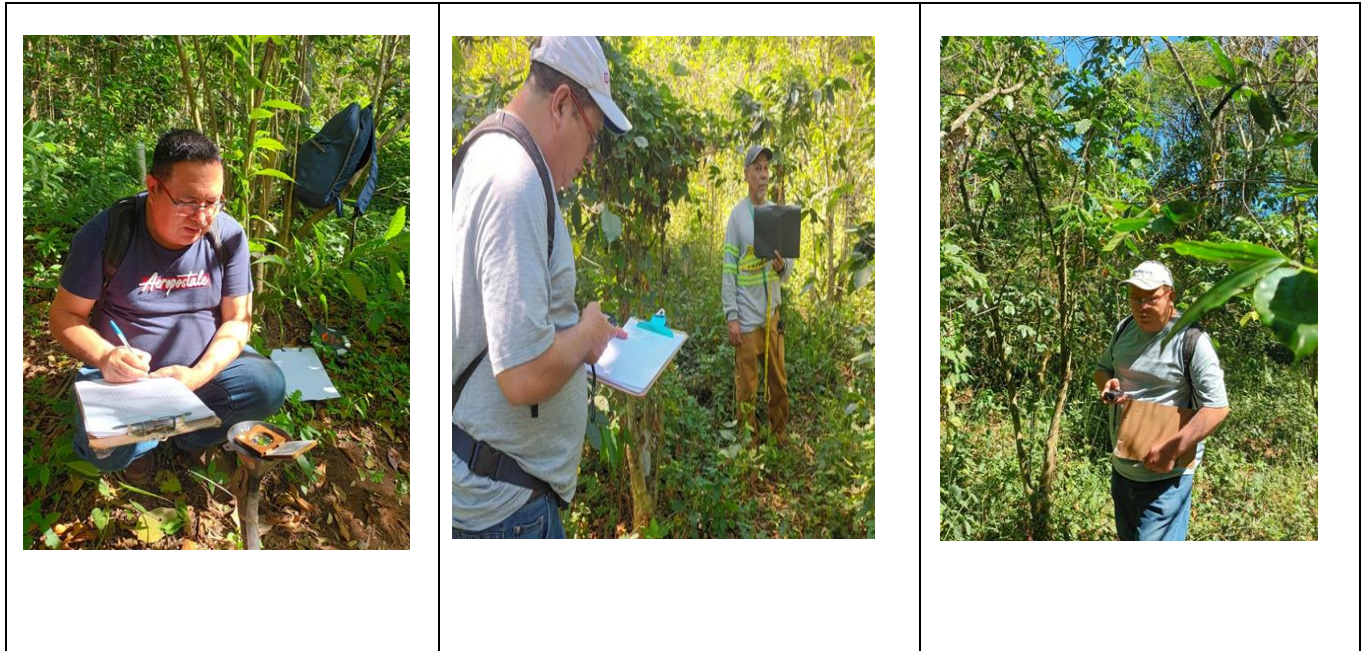
Haciendo uso del densímetro esférico y distanciómetro digital, para el cálculo de sombra y distancia entre del radio 5 m de cada punto de muestreo.
