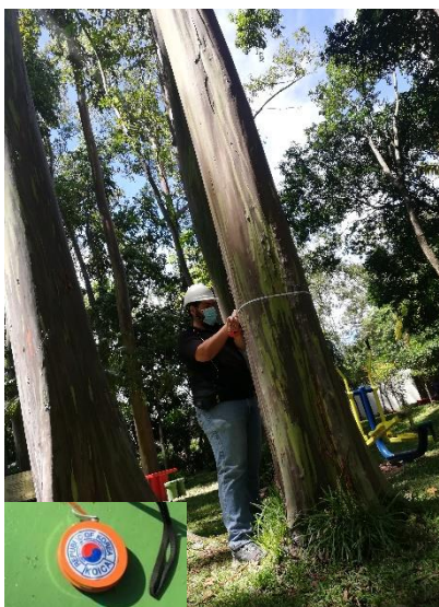
Figura 6. Medición de diámetro a 1.30 m con cinta diamétrica.
