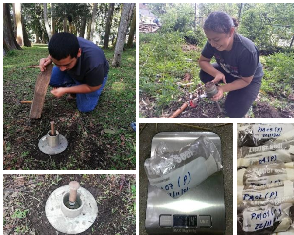
Figura 8. Equipo y material utilizado para muestras de suelo en campo.
