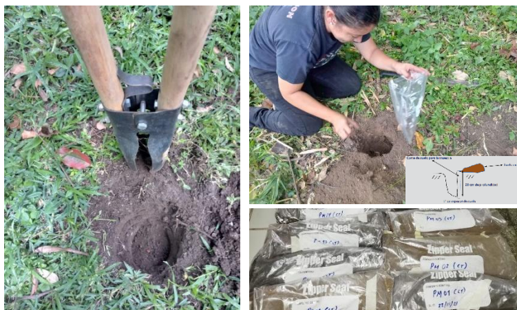
Figura 7. Toma de muestras para determinar captura de carbono en suelo.
