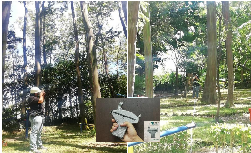
Figura 5. Toma de alturas en árboles con altímetro Haga.
