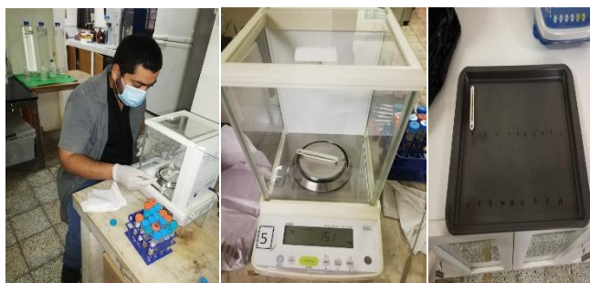
Figura 11. Preparación de muestras de suelo para análisis de carbono en el equipo TOC.
