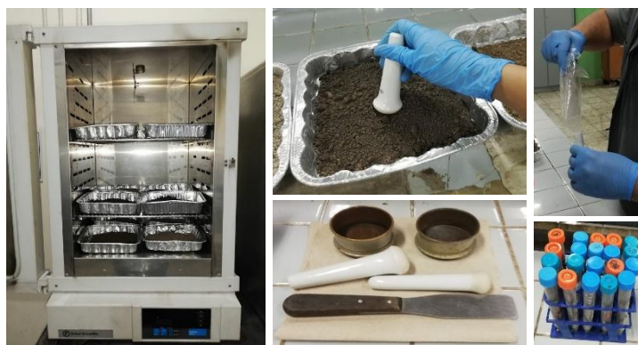
Figura 10. Preparación de muestras de suelo para análisis de carbono orgánico.
