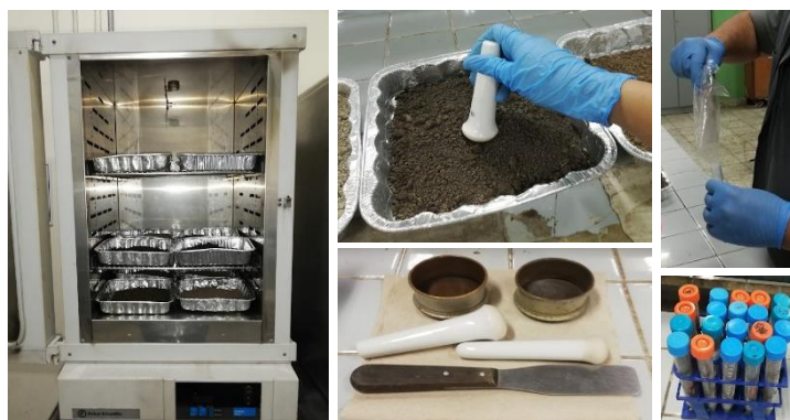
Figura 10. Preparación de muestras de suelo para análisis de carbono orgánico.
