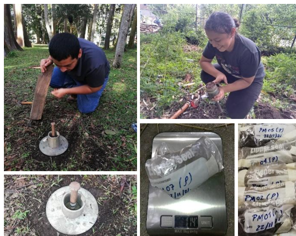
Figura 8. Equipo y material utilizado para muestras de suelo en campo.
