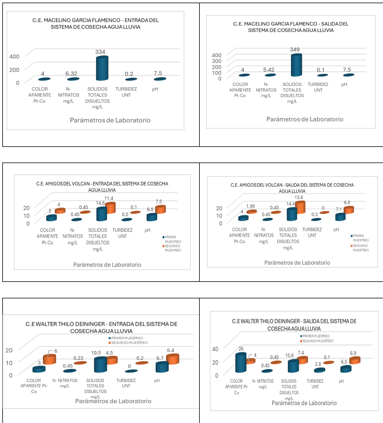
Fig. 7 parámetros físicos y químicos, de laboratorio a la entrada y salida del sistema de cosecha de aguas lluvias. Por centro escolares.
