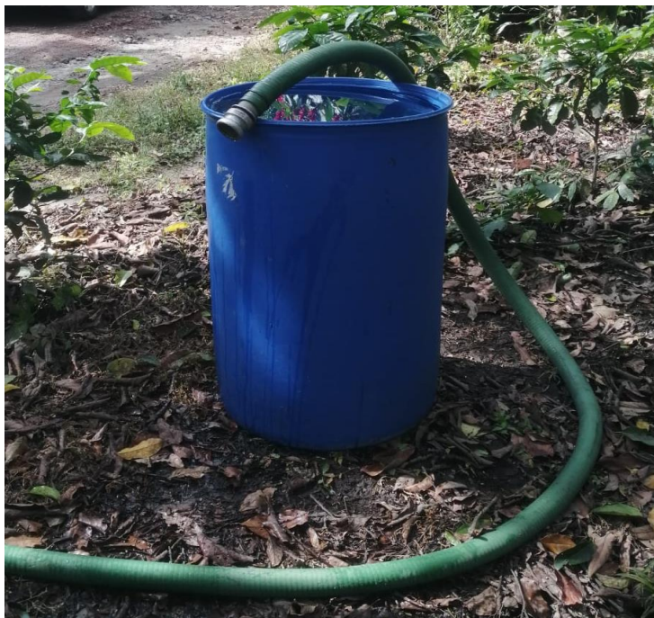
Figura 4.6. Cálculo de caudal con barril de 55 galones de capacidad.
