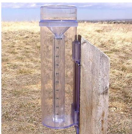
Figura 2.6. Pluviómetro estándar. Fuente: (Equipamiento Científico, 2023).
