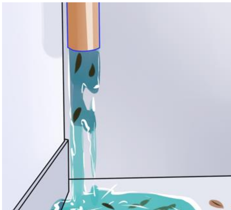
Figura 5.13 Lavado de bajada de aguas lluvias. Fuente: [Allen Lee, (2024)]
