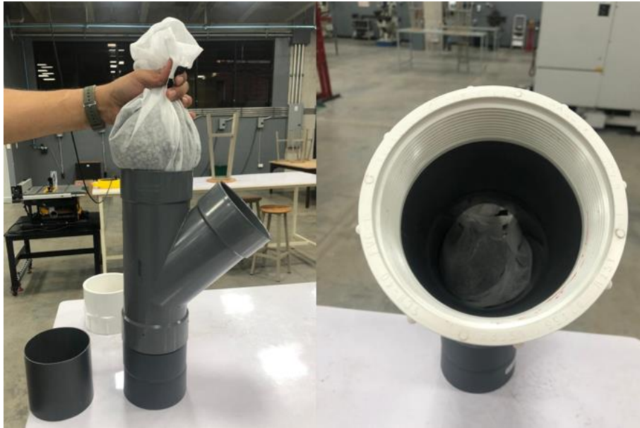
Figura 3.28 Instalación de bolsa de malla textil y grava en accesorio Yee de PVC para prueba de resistencia. Fuente: [Elaboración propia (2025)]
