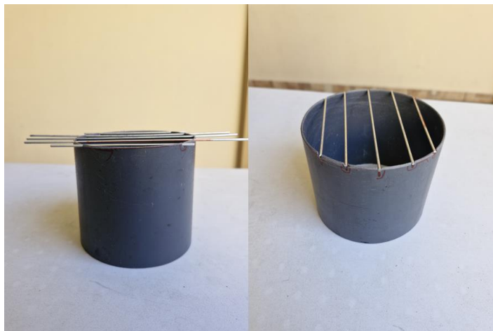
Figura 3.24 Sección de las varillas cortadas e instaladas. Fuente: [Elaboración propia (2025)]
