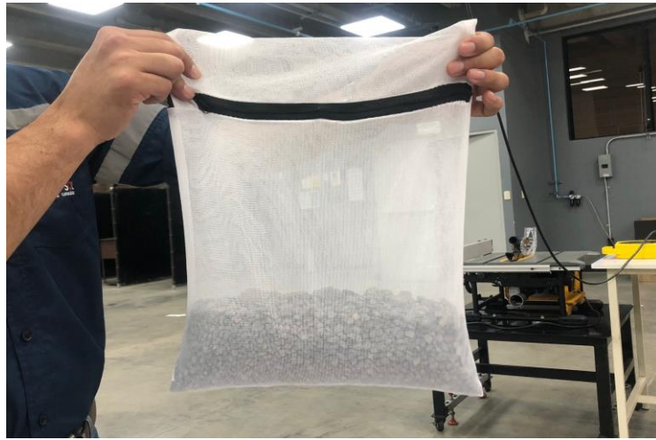
Figura 3.10 Bolsa de malla textil con grava #1. Fuente: [Elaboración propia (2025)]
