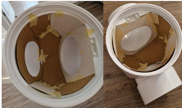
Figura 3.2 Elaboración de plantillas para válvula antirretorno. Fuente: [Elaboración propia (2024)]
