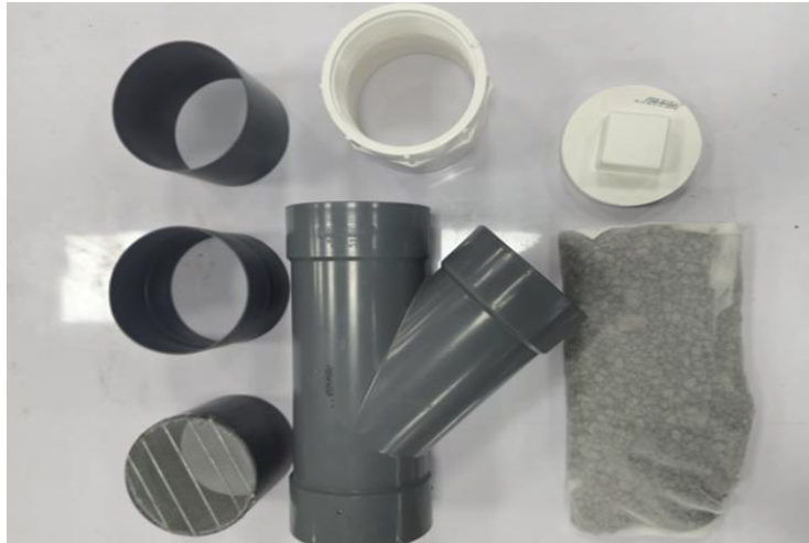
Figura 3.17 Materiales y componentes elaborados para el filtro con accesorio Yee de PVC. Fuente: [Elaboración propia (2025)]
