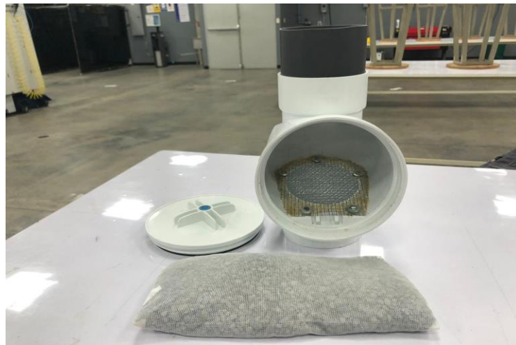
Figura 3.11 Elementos que componen el filtro para la válvula antirretorno. Fuente: [Elaboración propia (2025)]
