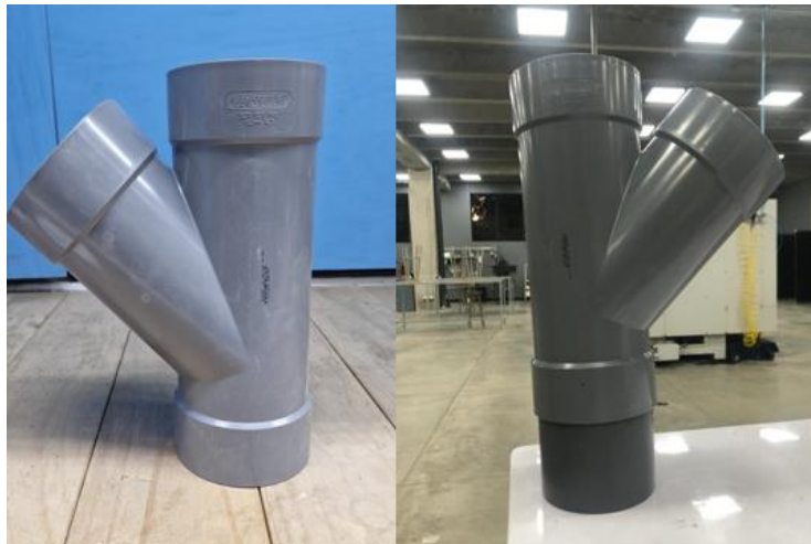
Figura 3.18 Accesorio Yee de PVC seleccionado para la elaboración del filtro. Fuente: [Elaboración propia (2025)]
