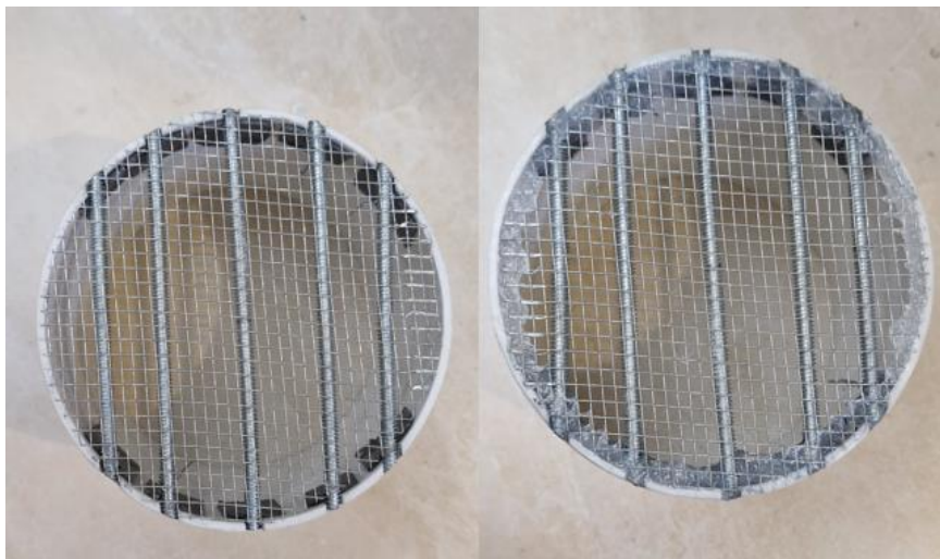
Figura 3.33 Recubrimiento de la base con silicón industrial para evitar fugas. Fuente: [Elaboración propia (2025)]
