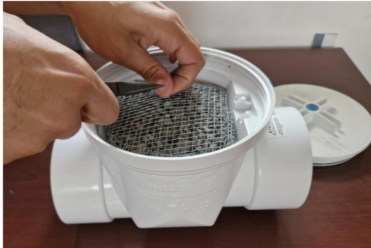
Figura 3.5 Prueba de dimensionamiento de filtro. Fuente: [Elaboración propia (2025)]
