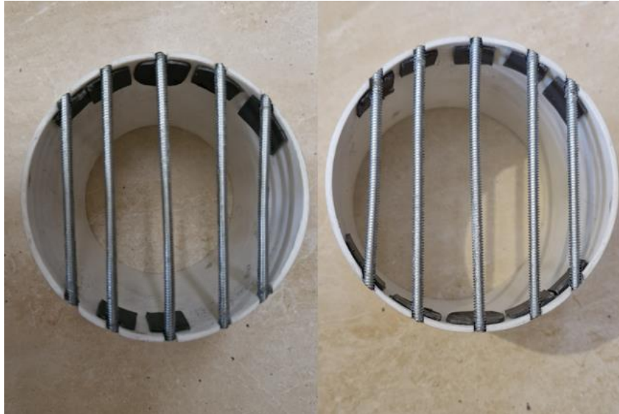
Figura 3.31 Elaboración de segunda base con varillas corrugadas y tacos de PVC de soporte. Fuente: [Elaboración propia (2025)]
