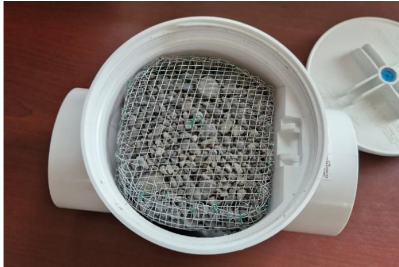
Figura 3.7 Válvula antirretorno con filtro de grava. Fuente: [Elaboración propia (2025)]
