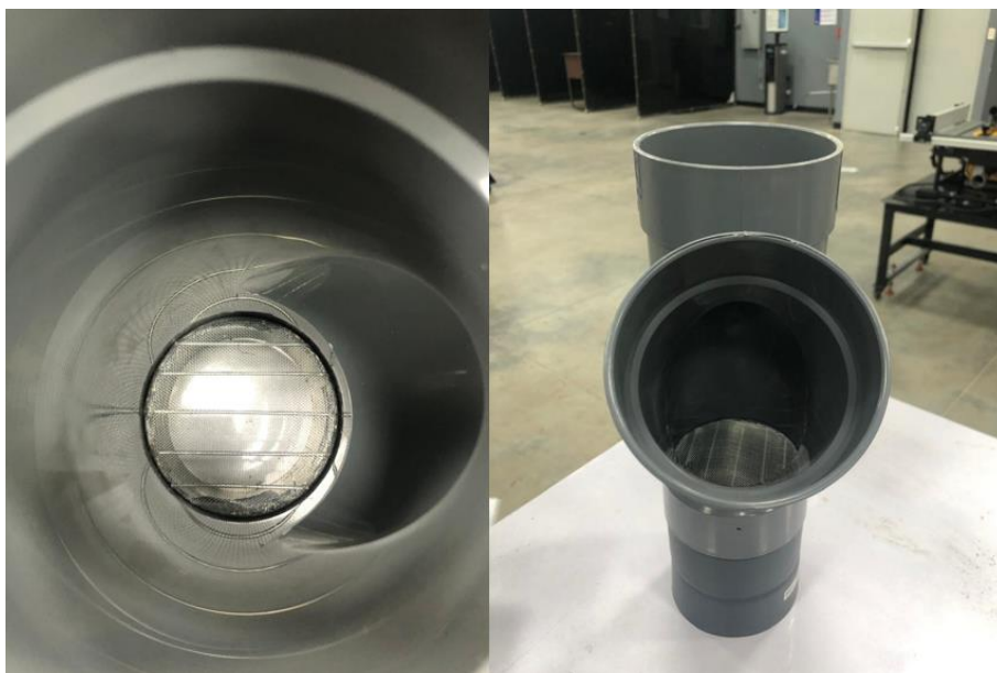
Figura 3.27 Instalación de base de refuerzo en accesorio Yee de PVC. Fuente: [Elaboración propia (2025)]
