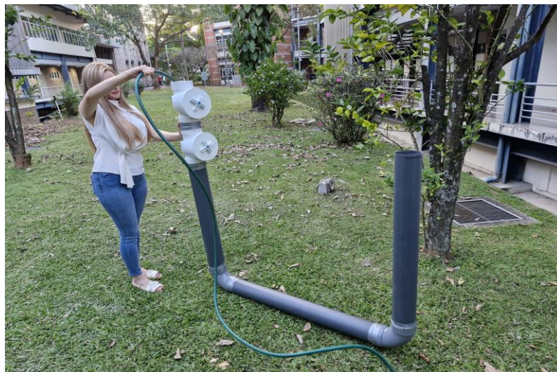
Figura 3.15 Prueba de los filtros de grava en la válvula antirretorno. Fuente: [Elaboración propia (2025)]
