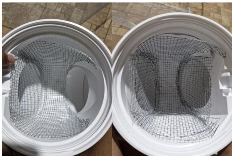
Figura 3.4 Corte de malla galvanizada. Fuente: [Elaboración propia (2025)]
