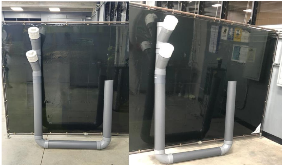
Figura 3.29 Prueba del SCALL a menor escala con 2 accesorios Yee de PVC y filtros con bolsa de malla textil. Fuente: [Elaboración propia (2025)]
