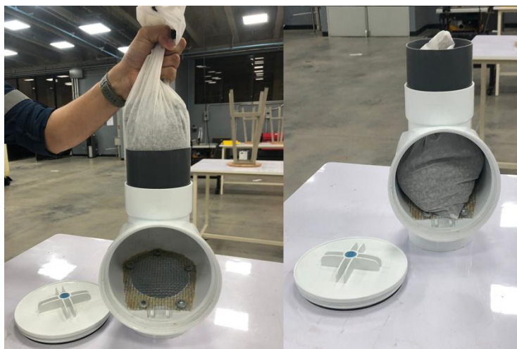
Figura 3.12 Colocación de bolsa de malla textil con grava en la válvula antirretorno. Fuente: [Elaboración propia (2025)]
