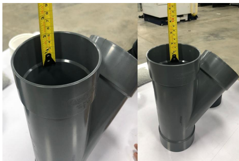
Figura 3.20 Toma de medidas de la balona del accesorio Yee de PVC. Fuente: [Elaboración propia (2025)]
