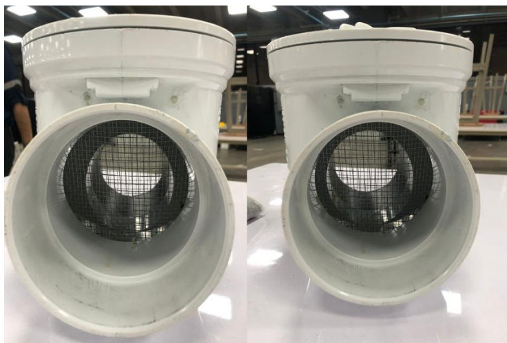
Figura 3.8 Sección de válvula antirretorno con malla galvanizada de refuerzo. Fuente: [Elaboración propia (2025)]
