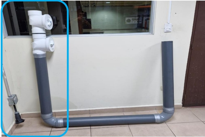
Figura 3.14 Sistema a escala para prueba de filtros con 2 válvulas antirretorno. Fuente: [Elaboración propia (2025)]
