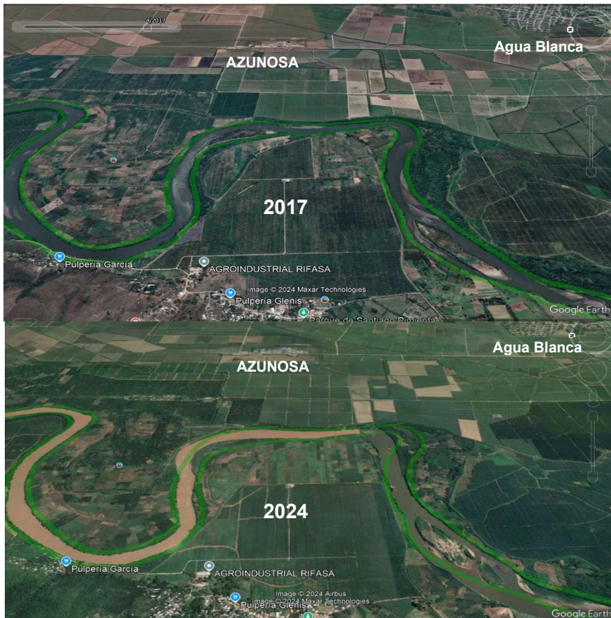
Ilustración 5. Efecto comparativo en la configuración de los márgenes en el río Ulúa entre 2017 y 2024 causado por erosión hídrica de la ribera del río. La línea verde representa el área de amortiguamiento de 50 m que por ley debe dejarse.
