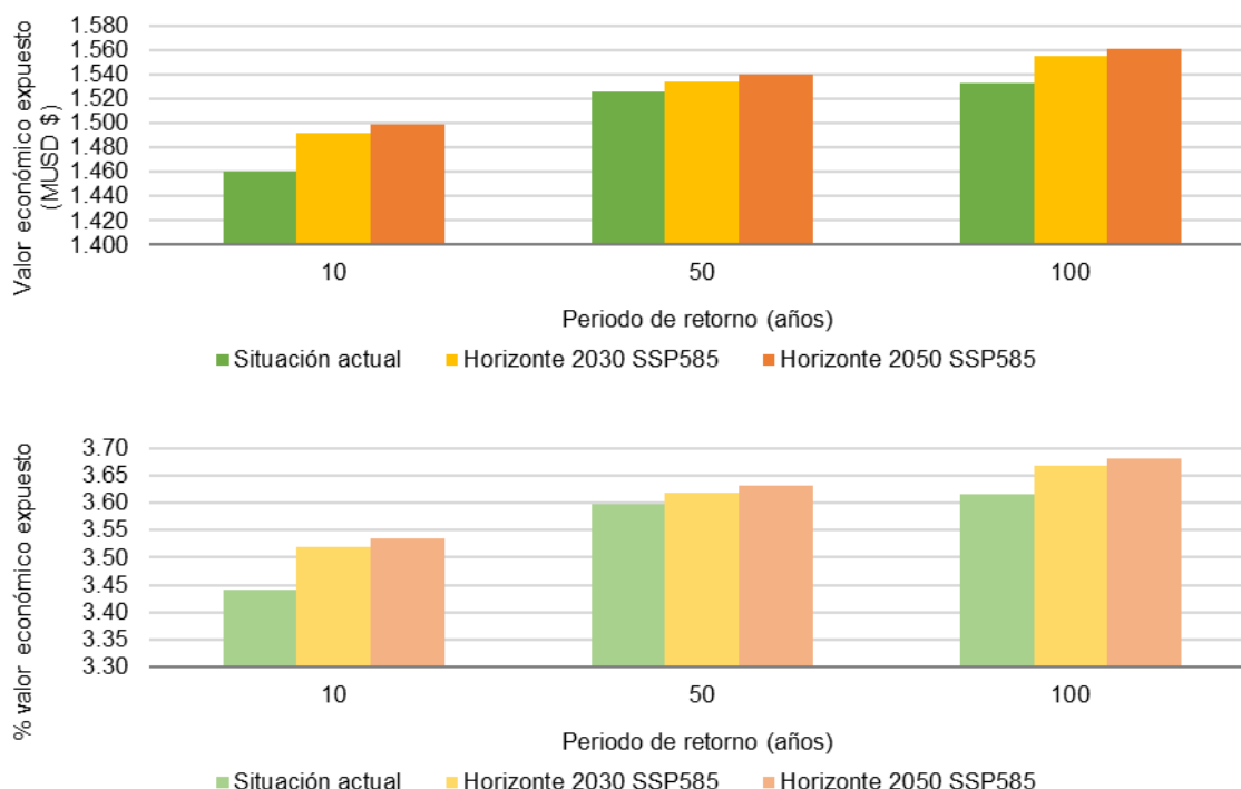
Figura 80. Valor económico expuesto de IC (MUSD $) para cada periodo de retorno y escenario climático. Los valores relativos se calculan respecto del total inventariado. Fuente: IHCantabria, 2024.
