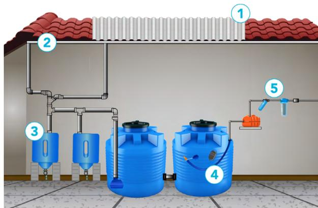
Figura 9. Esquema de funcionamiento de un Sistema de Captación de Agua de Lluvia (SCALL).
