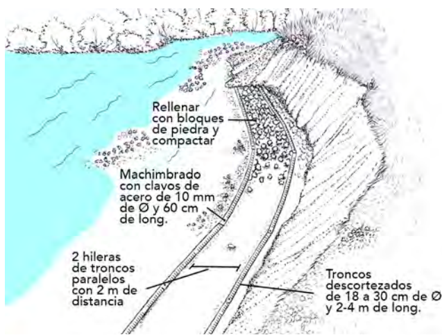
Primer nivel de troncos horizontales.
