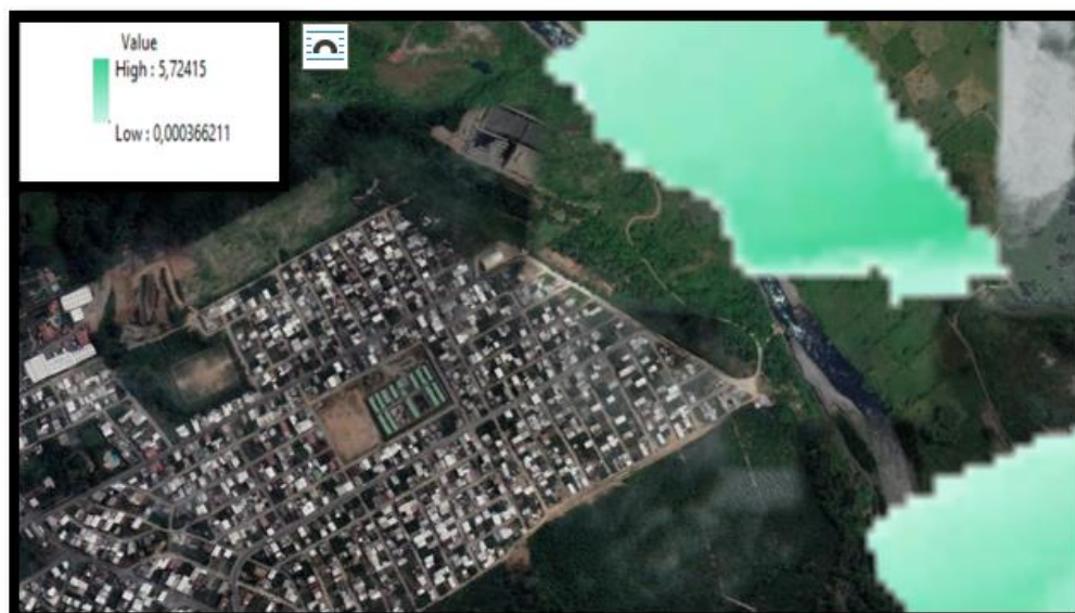
Figura 118 Zonas inundadas en Sueño de Bolívar y profundidades de inundación
